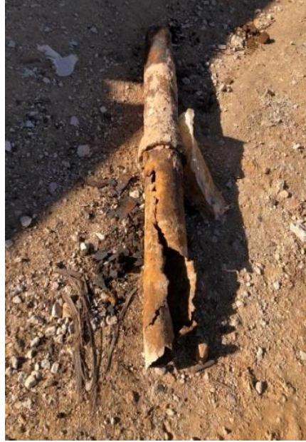
شكل 4: التسرب من شبكات المياه بمدينة زليتن (لجنة زليتن، 2024)
