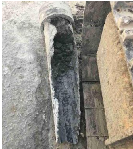
شكل 5: تسرب مياه الصرف الصحي نتيجة لتلف الأنابيب (أمهني والنعاس، 2019).
